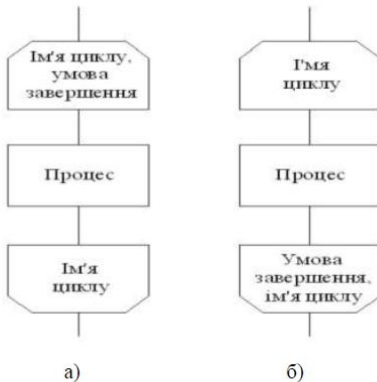
Рис. 3 – Блок-схеми для циклічного алгоритму: а) цикл з передумовою; б) цикл з постумовою.
