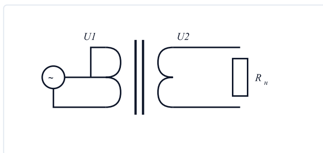
Рис 2.1. Схема випробування однофазного трансформатора
