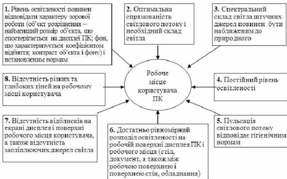
Рис. 7.4. Схема вимог до освітлення робочого місця користувача ПК з першоджерела.
