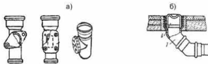
Рисунок 7.5 — Ревізія та прочистка як доступні елементи технічного контролю (за [5, с. 290], рис. 3.18).
