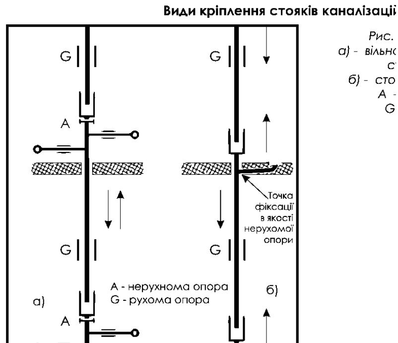
Рис. 6.4. Варіанти кріплення каналізаційних стояків до будівельних конструкцій
