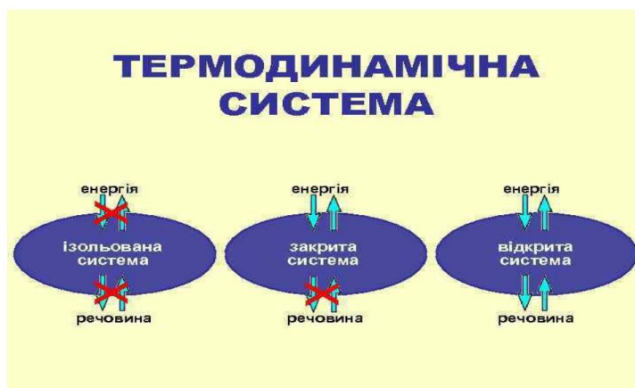
Рис. 6.1. Схематичне порівняння відкритої, замкнутої та ізольованої систем
