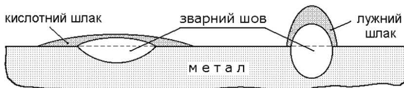
Рис. 19.2. Ілюстрація впливу властивостей шлаку на форму поверхні зварного шва
