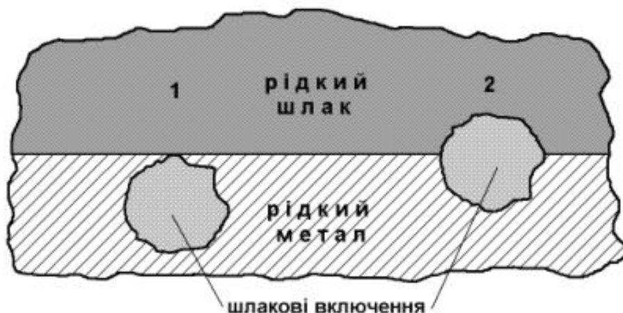
Рис. 22.2. Можливе розташування неметалевих включень на межі металу і шлаку
