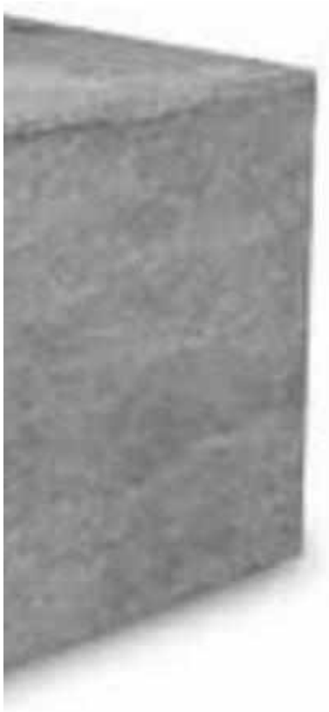
Рисунок 10.2 – Стандартний бетонний куб для визначення міцності на стиск (джерело: [3], с. 21, рис. 2.4)
