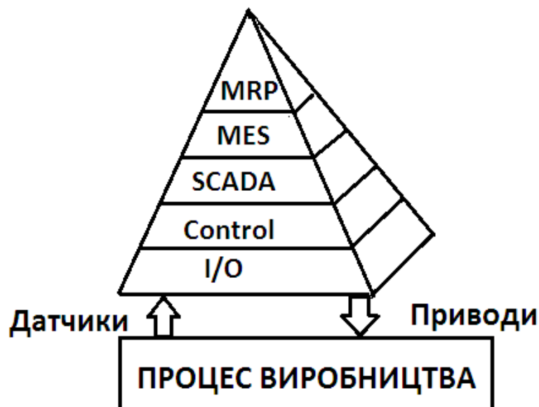
Рисунок 1.5. Рівні автоматизації комп'ютерно-інтегрованого виробництва
