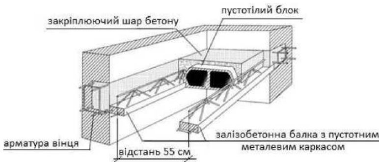
Рис. 6.19. Конструкція перекриття «Терріва»
