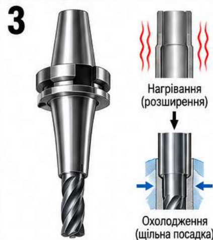
Термопатрон Термічна посадка інструмента Ø12 мм
