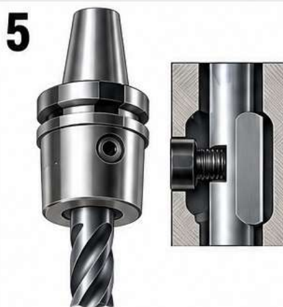
Оправка з боковим гвинтом Затиск на площині хвостовика Ø16 мм · Weldon
